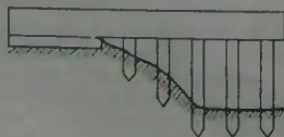
Рис. 5. Пример выбора типа фундаментов при крутом залегании кровли крупнообломочных и скальных грунтов
